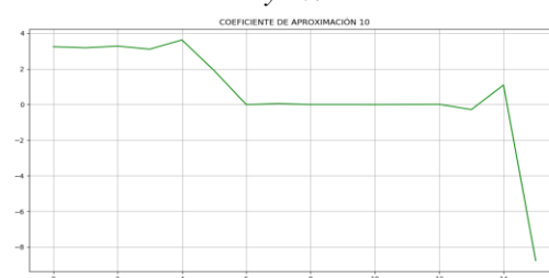
Fig. 14. Registro en el sistema Raspberry Pi, Análisis Multi resolución señal Sag, aproximación 10.
