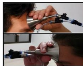
Fig. 4. Ubicación del embudo para la medición de compuestos orgánicos volátiles.
